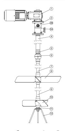
Pos. 1: Gearmotor Pos. 2: Gear console Pos. 3a: CIP entry Pos. 3b: Aeration entry Pos. 4: Down pipe
