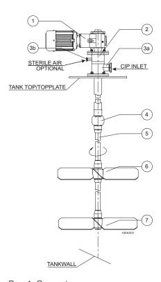
Pos. 1: Gearmotor Pos. 2: Gear console
