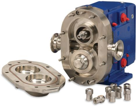
Alfa Laval 로터 날개(피스톤)는 펌프 케이싱에 있는 채널의 원주 주위를 회전합니다. 이렇게 하면 로터 메시가 해제될 때 흡입 포트에서 부분적인 진공이 생성되어 유체가 펌프로 유입됩니다. 유체는 로터 날개에 의해 채널 주변으로 전달되며 로터 날개가 집중될 때 배수되어 배출 포트에 압력이 생성됩니다. 흐름 방향은 반대로 할 수 있습니다.
